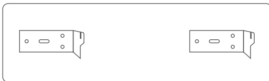
An der Wand montierte Stützen (Abb. 2)
